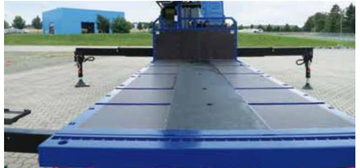
Hydraulischer Heckauszug 4 t mit mechanischem Unterfahrtschutz
