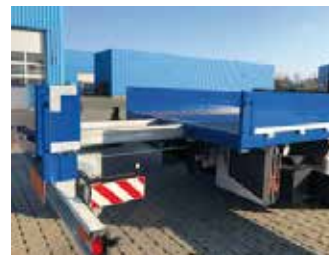
Hydraulischer Heckauszug 4 t
